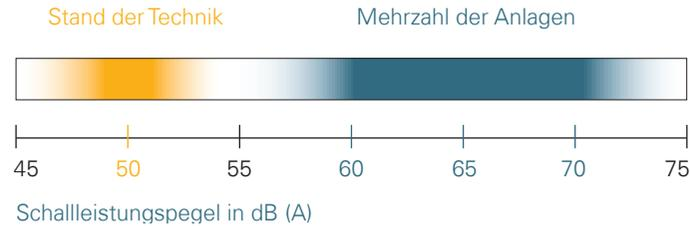
Die Mehrzahl der verbauten Geräte entspricht nicht dem Stand der Schallschutztechnik. Das heißt, sie sind zu laut.
